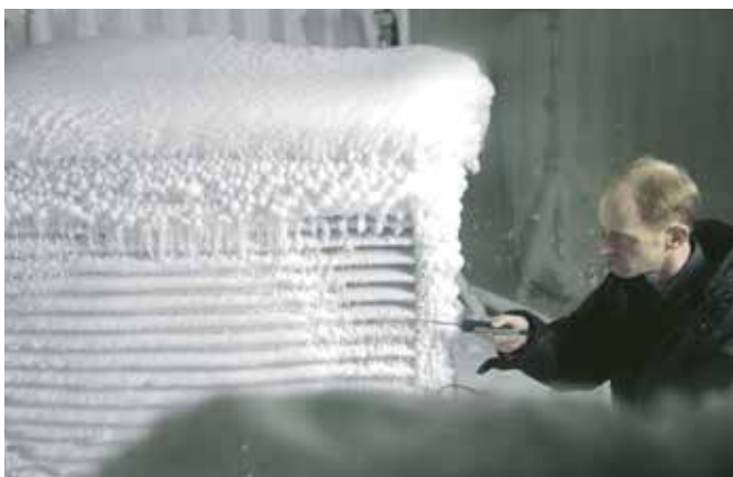
I kølerummet testes varmepumperne under ekstreme temperaturer.
