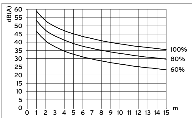
Fig. 6.5 Støjniveau fra to udeenheder i dB(A) afhængigt af afstand og ventilatorens omdrejningstal VWL 171/3 S ved opstilling i det fri
