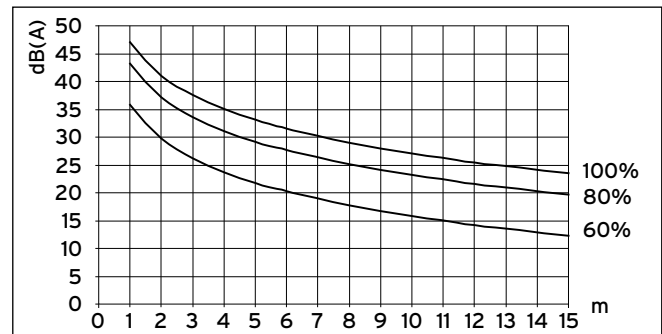
Fig. 6.1 Støjniveau fra en udeenhed i dB(A) afhængigt af afstand og ventilatorens omdrejningstal til VWL 61/3 S ved opstilling i det fri
