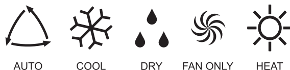
Fig. 7.9 Driftstilstande.
