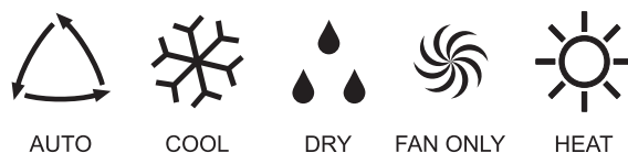
Fig. 7.6 Modos de funcionamiento.
